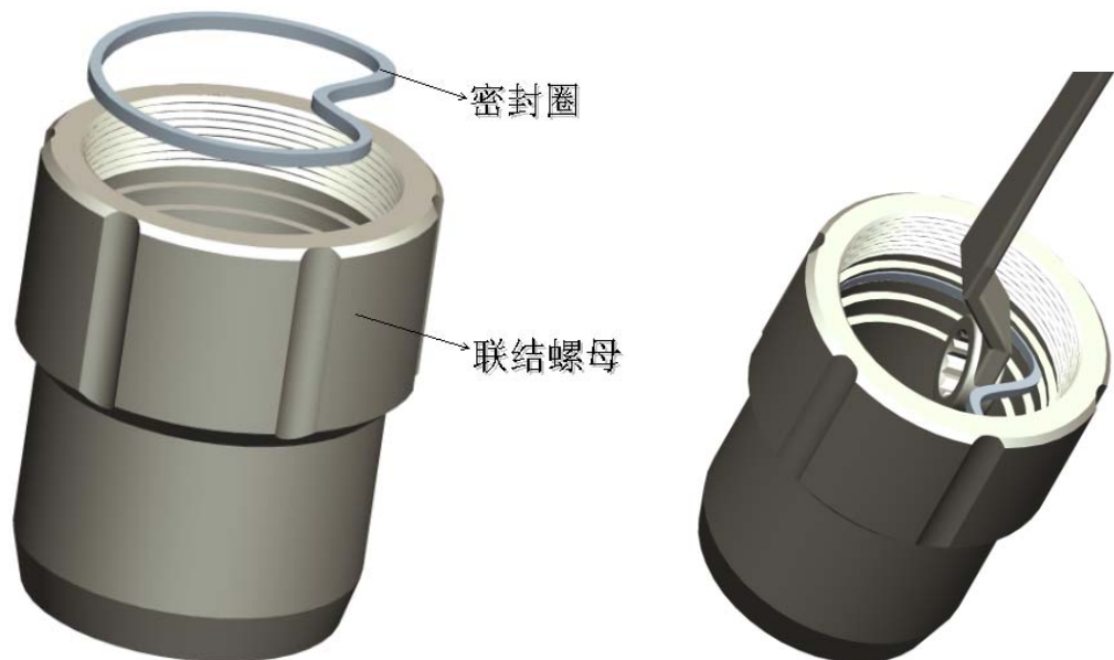
图六 矩形密封圈的装配示意图
